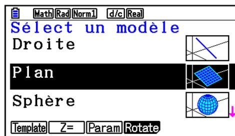
Puis, on va créer, en objet 2, un plan par la donnée de 3 points en appuyant sur **F3** **{TYPE}**, choisir un plan et taper **EXE**, **F3** **{POINTS}** et enfin en saisissant les coordonnées des points A, C et H.
